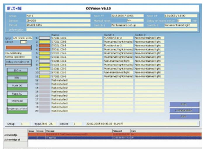
Auch auf der Stromkreisebene bekennt die Software „Farbe“. Wie ist der Status der Leuchten? Sind die bis zu 20 Leuchten ausgeschaltet oder defekt? Ein Blick genügt.
