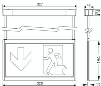
\* Deckenmontageset für GuideLed 11024 und Betoneinbaukasten entsprechen Schutzklasse I
