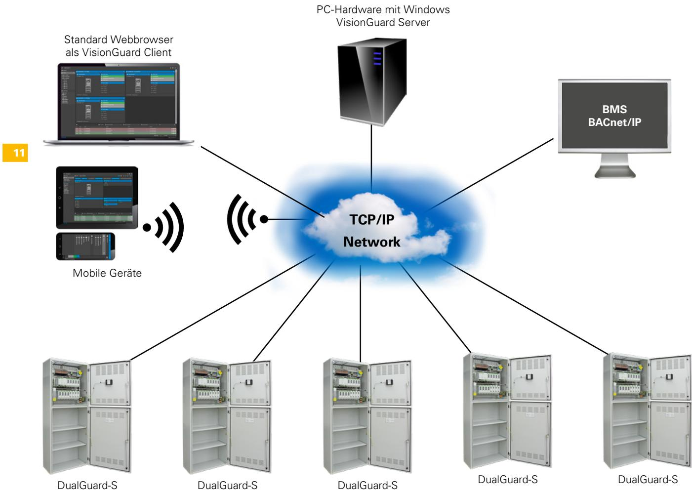
Eine optional erhältliche BACnet/IP-Schnittstelle ermöglicht die Verbindung eines externen Gebäudemanagementsystems (BMS) über das BACnet Protokoll. Die BACnet-Schnittstelle bietet zahlreiche Statusmeldungen und vier analoge Batteriewerte pro DualGuard-S Zentralbatteriesystem.
